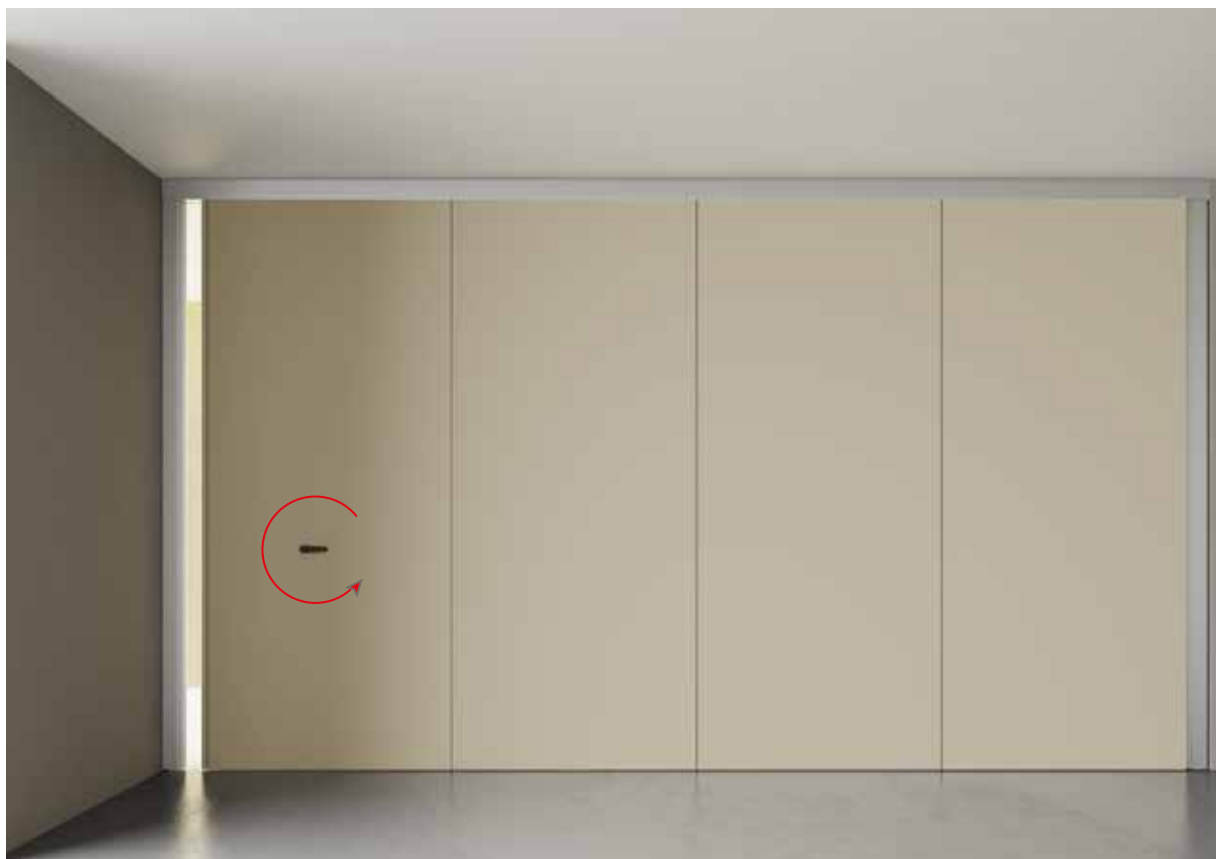
2. Si posiziona la manovella nell'apposito occhio metallico e si comincia a girare la manovella. In questo modo il pannello telescopico laterale si muove all'interno del modulo. La parete è sbloccata. 2. Place the crank in the appropriate metal eyelet and start turning the crank. In this way the telescopic side panel moves inside the module. The wall is unlocked.
